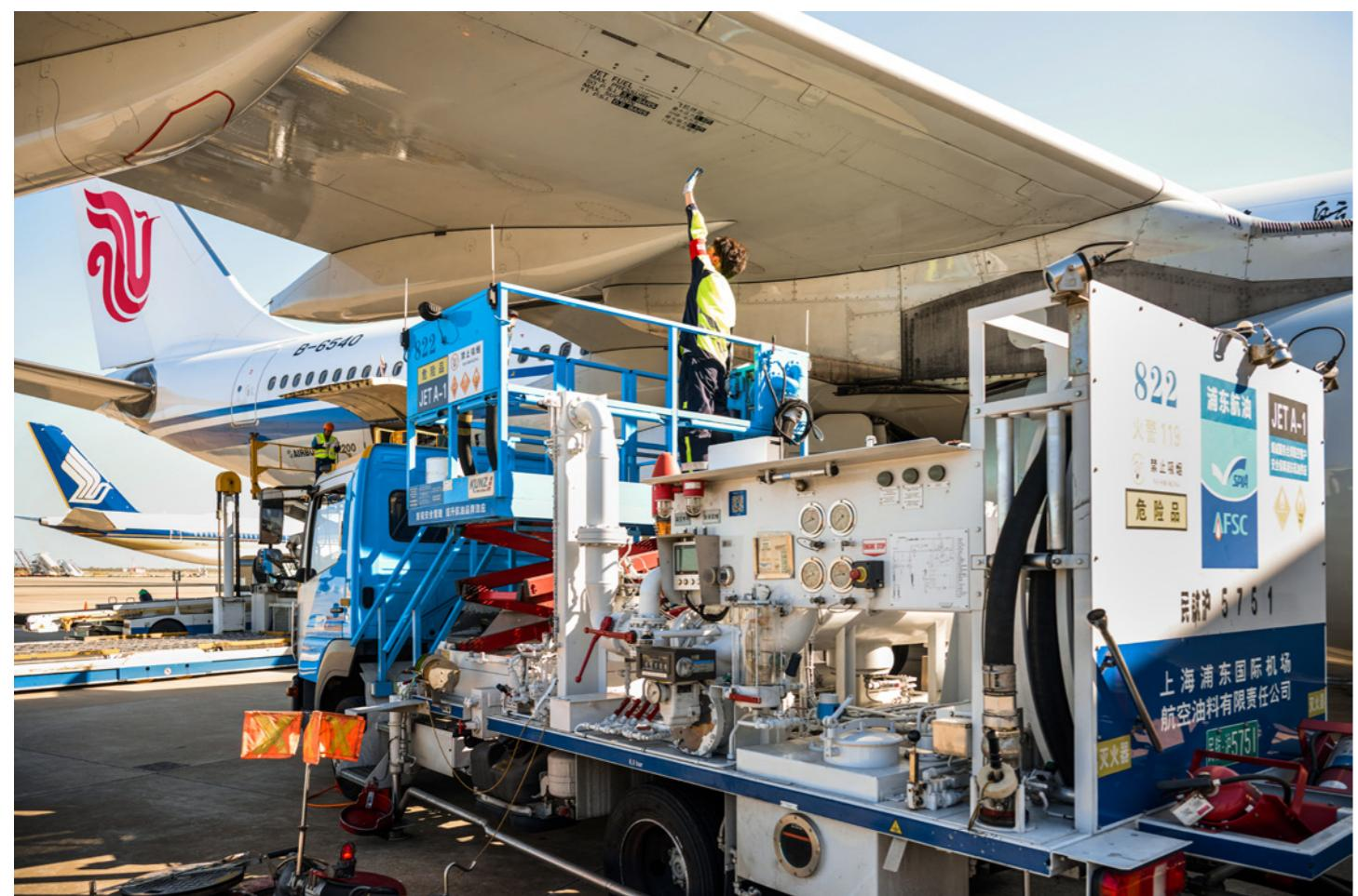
进博的重要航班保障，与普通航班有着不少差异，对加油车辆的要求更加复杂。航班抵离时间也比商业航班存在更多变数，需要航油部门不断调整、随机应变。飞机加油员需要结合机位、飞机机型、飞机受油口、地井位置等信息，驾驶飞机加油车停靠在合理的加油位置，连接导静电线、地井接头、加油接头等，安全、及时、准确地加注航油。
